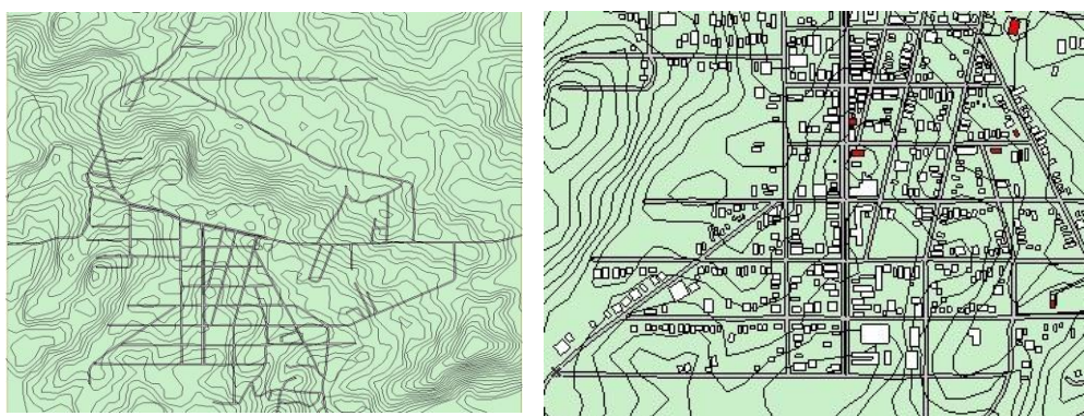
Figura 2. Levantamento planialtimétrico via satélite com interpolação de curvas de nível (esq.) e subsequente mapeamento manual das construções da cidade com base em imagens via satélite (dir.)
